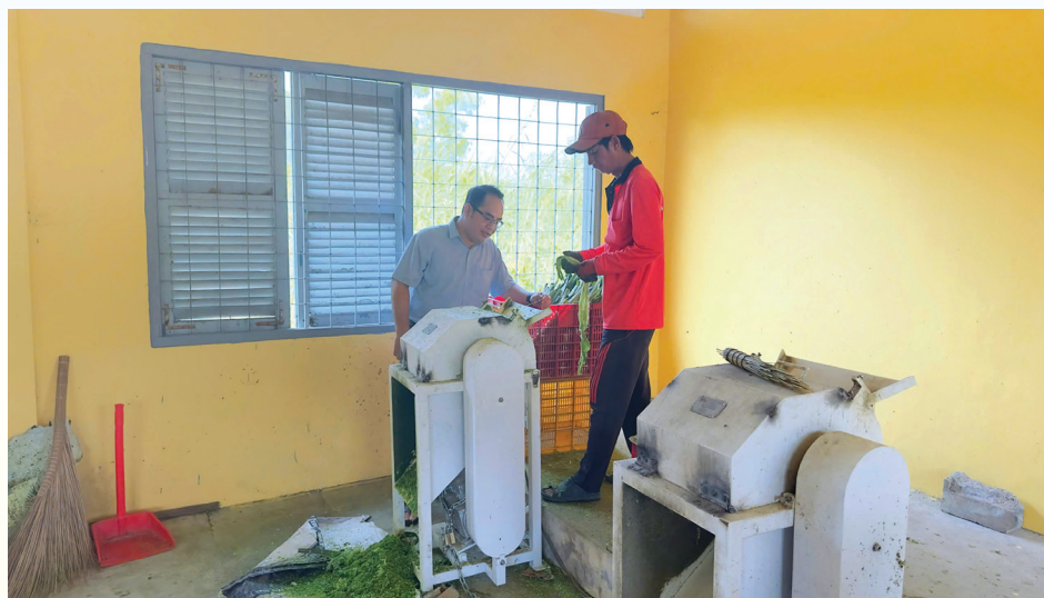
Máy đánh sợi tơ từ lá khóm (mua của ECOSOI) được anh Quyền cải tiến để đảm bảo an toàn
